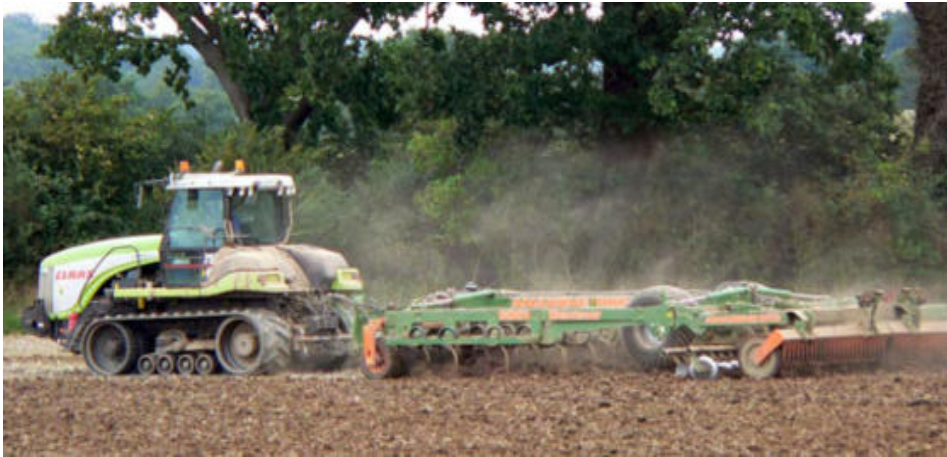
Abb. 32: Raupe und Centaur mit automatischer Tiefenführung (Foto: Obenauf)
