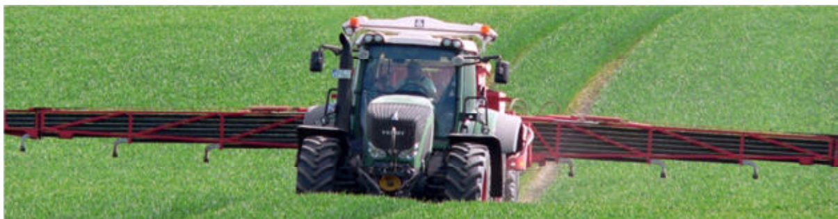
Abb. 52: Yara N-Sensor auf dem Schlepperdach (Foto: Obenauf)
